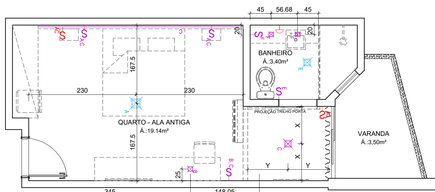
PLANTA BAIXA - ILUMINAÇÃO ESCALA 1/50
