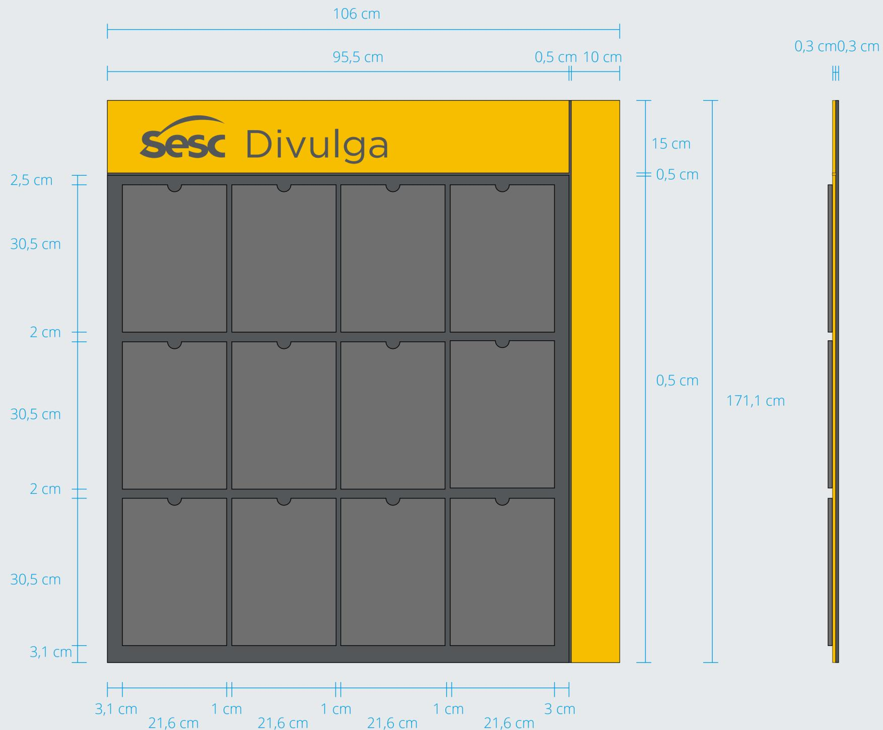
O quadro de aviso contém um módulo com 12 bolsas em acrílico, havendo necessidade esse modo poderá ser ampliado.
