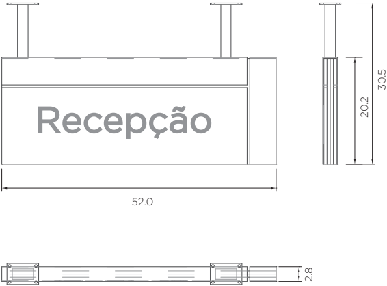
Peças montadas vistas ortográficas
