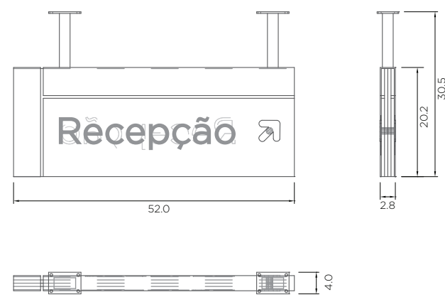
Peças montadas vistas ortográficas
