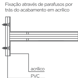
Detalhamento fixação na parede
