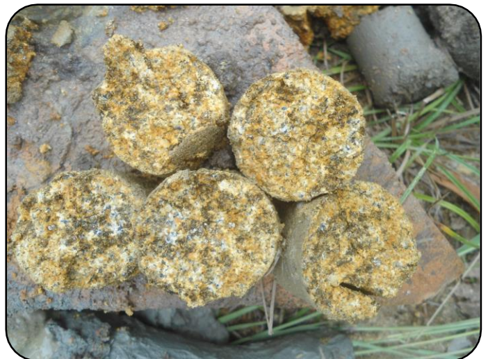
Figura 4: Amostras representadas de acordo com a linhas: i) material de aterro; ii) areia média a grossa; iii) argila cinza com areia fina, em destaque um pedaço de concha e as marcas de raiz; e iv) argila siltosa com areia média de cor variegada, apresentando as estruturas ígneas preservadas (saprólito de rocha).
