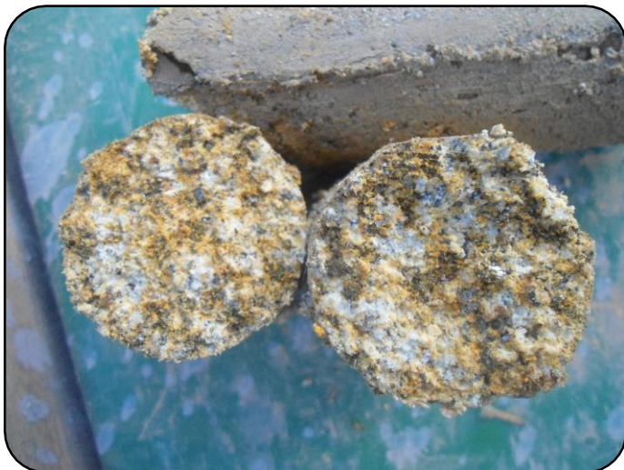
Figura 4: Amostras representadas de acordo com a linhas: i) material de aterro; ii) areia média a grossa; iii) argila cinza com areia fina, em destaque um pedaço de concha e as marcas de raiz; e iv) argila siltosa com areia média de cor variegada, apresentando as estruturas ígneas preservadas (saprólito de rocha).
